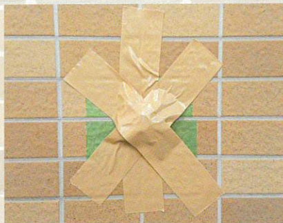
2 45mm × 45mm アタッチメントを接着剤にて貼り付ける
