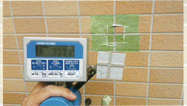
5 目地モルタル強度確認結果が 60N/cm 以上で当該工法の対象となります
