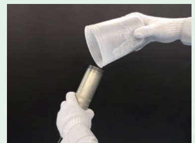
ヘラ乗りが悪い時は注入ポンプへ直接流し入れる様に充填します。
