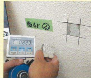
GNSフィラー付着力試験
